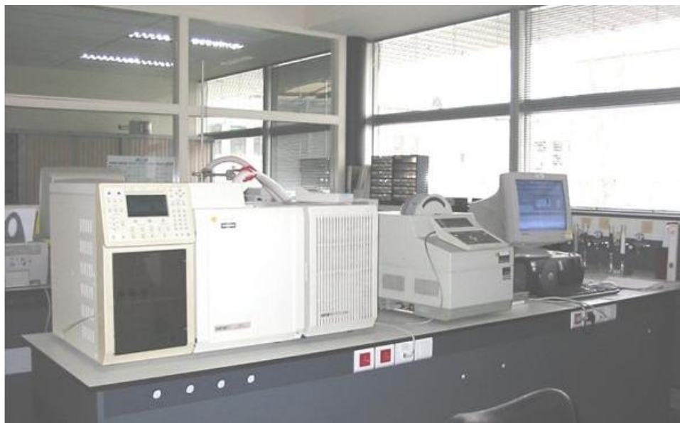
Figure 13 : Chaine analytique TD/GC/MS/FID utilisée au CSTB
