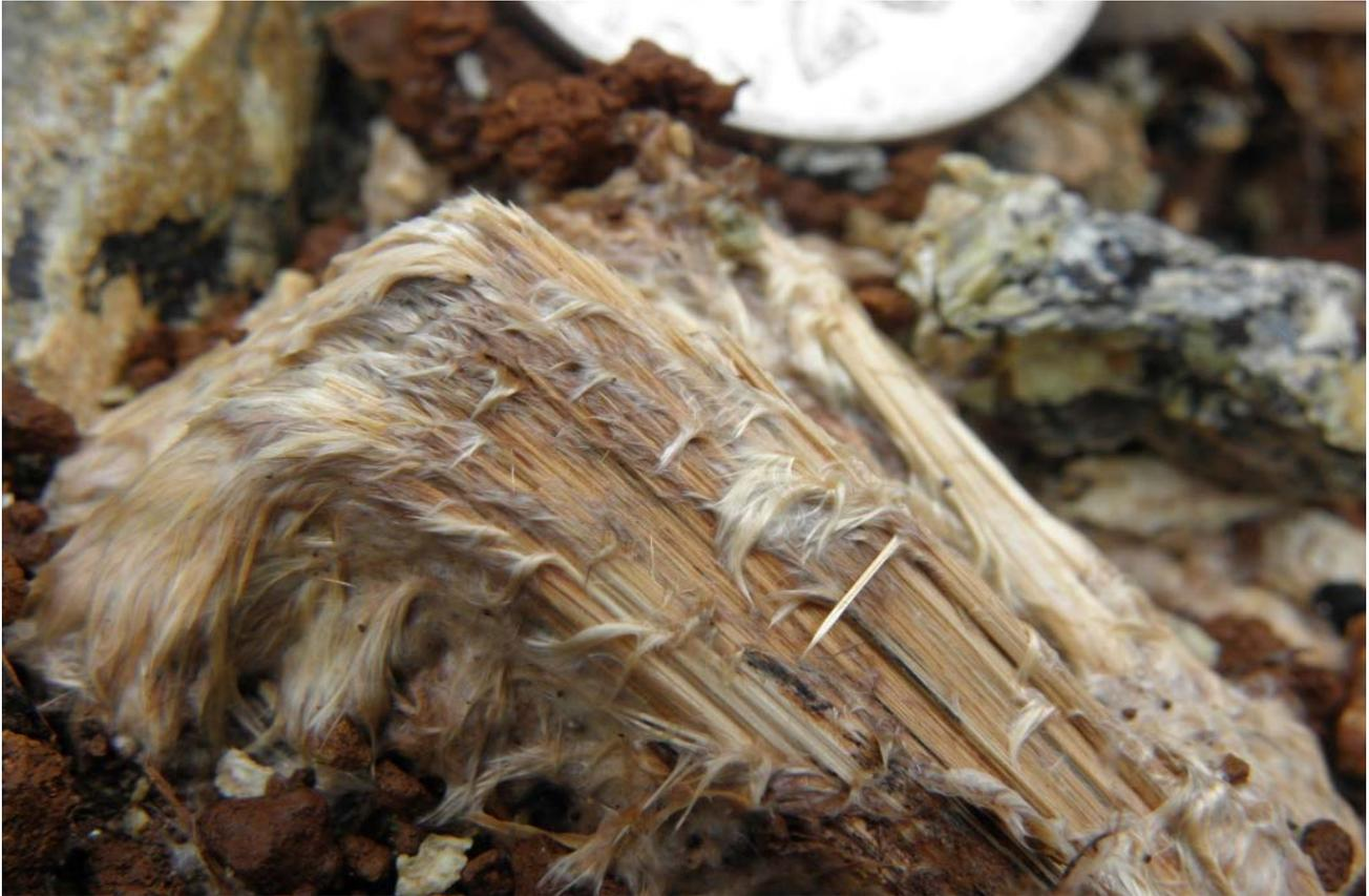
Photo 4 : Faisceau de trémolite-amiante, Massif du Sud, Nouvelle-Calédonie (© BRGM – Didier Lahondère).
